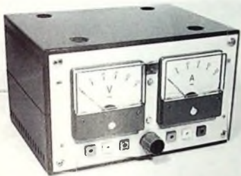
Bild 1. Ansicht des Netzgerätes für positive und negative Spannungen von 8 bis 20 V
