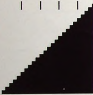
Bild 8. Programmstreifen zur Aufnahme der Eichkurve
