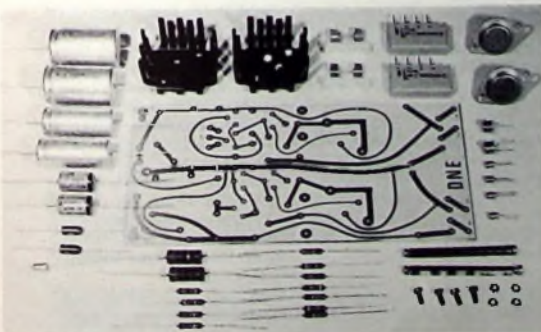
Bild 3. Zum Bau des Netzgerätes für positive und negative Spannungen erforderliche elektronische Bauteile
