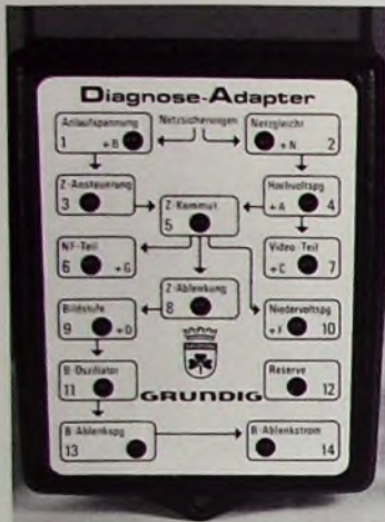
Bild 3 Frontansicht des Diagnose-Adapters mit den in Form eines Blockschaltbildes angeordneten Leuchtdioden
