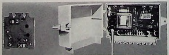
Bild 1 Kleinverstärker „S43309 V A“ für einen Kanal im Bereich III; links: Verstärkereinsatz, rechts: Verstärker im Kleingehäuse „S43101 N A“ mit Netzteil (für Unterdachmontage)
