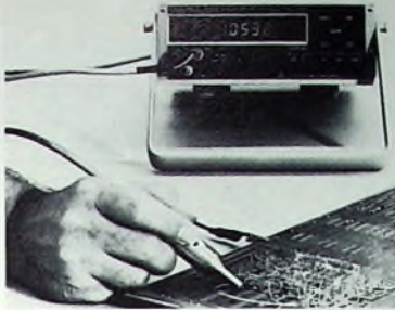
Bild 3. Digital-Multimeter „TA 365“ mit „Touch-'n-Hold“-Tastkopf
