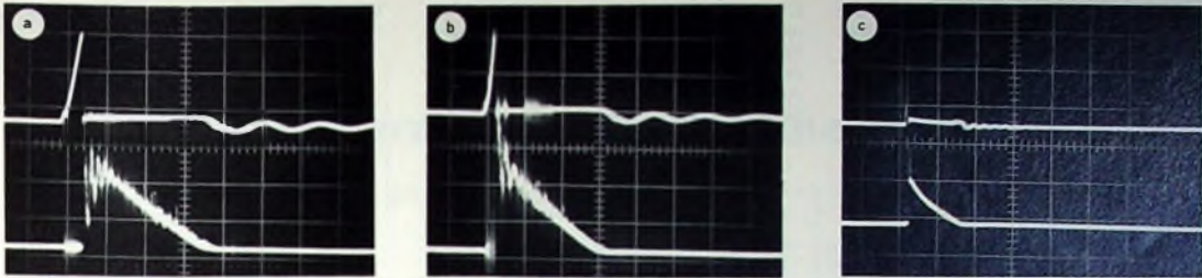
Bild 4 Funkenentladungen einer HKZ nach Bild 2 b
