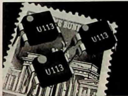
Bild 1: Monolithisch integrierter Berührungsschalter U 113 (AEG-Telefunken)
