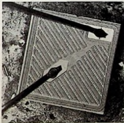
Bild 8: Chip des epitaxialen NPN-Silizium-Transistors BU 406 / BU 407 für Horizontalablenk-Endstufen (SGS/Ates)
