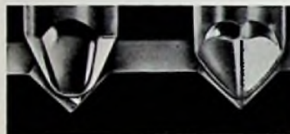
Bild 8: „Pramanik“-Diamantnadel (rechts) zum Abtasten von CD-4-Frequenzmodulationen im Bereich 20 000 ... 45 000 Hz; im Vergleich dazu (links) eine elliptische Diamantnadel
