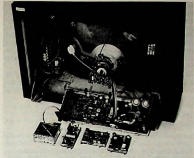
Bild 1. In den neuen Modul-Chassis für Metz-Schwarz-Weiß-Fernsehempfänger sind die Modul-Steckkarten und sonstigen Baugruppen steckbar ausgeführt
