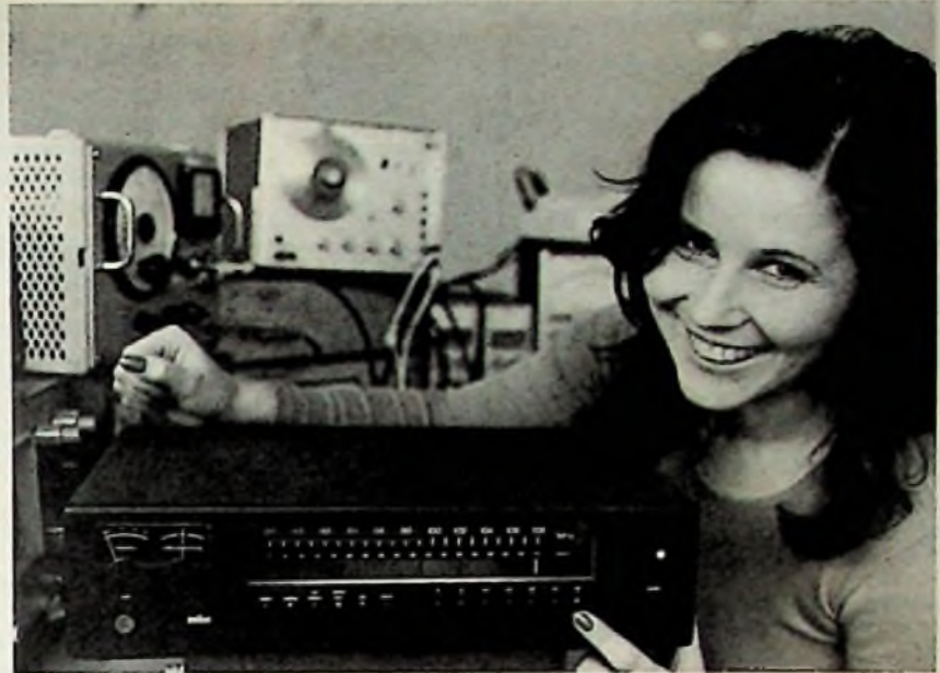
Oben: Als Entwicklungsstudie wurde dieser Hi-Fi-Tuner der Firma Braun mit einer aus Flüssigkristallen bestehenden Skala versehen, die in Zusammenarbeit mit Siemens entstanden und elektronisch angesteuert wird.
