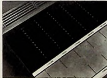
Bild 4: Bedienelemente des Quadro-Receivers „Beomaster 6000“ mit Anzeigefeldern und großflächigen Tiptasten
