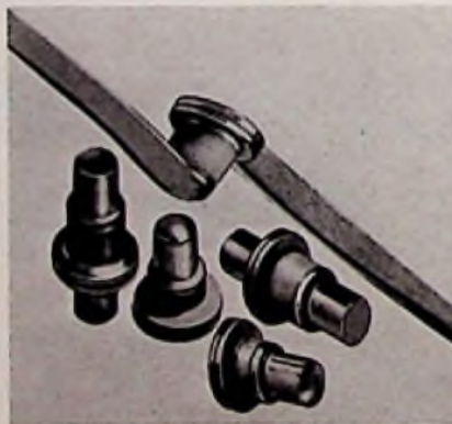
Bild 1. Neue Varaktor-Diode für den Frequenzbereich 4 bis 14 GHz (ITT-Intermetall)
