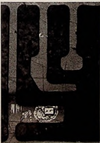
Bild 3. Chip des neuen HF-Transistors BF 506 (SGS-Ates)
