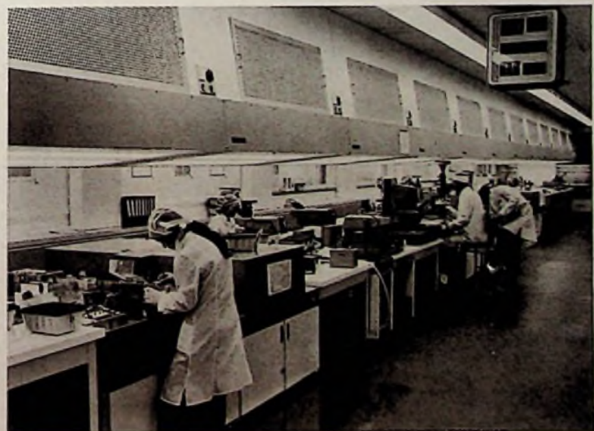
Bild 2. Über diesen fototechnisch arbeitenden Masklertischen sind spezielle Laminarboxen als Luftzuführung angeordnet, die durch tatenten Überdruck besondere Sauberkeit garantieren
