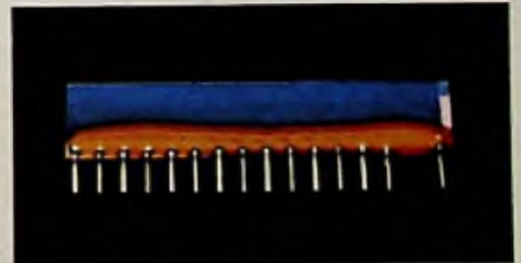
Dickschicht-Schaltung. Originalgröße 15 x 40 mm.
