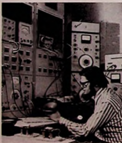
Bild 8. Lautsprecher-Prüfung im Schall-Meßraum
