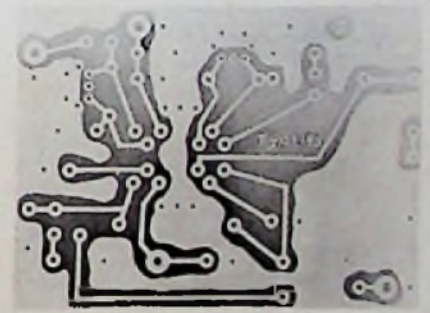
Bild 11. Anwendungsschaltung der TDA 1043 mit elektronischer und konventioneller Lautstärkeinstellung; Fußpunkt des Lautstärkepotentiometers an Masse
