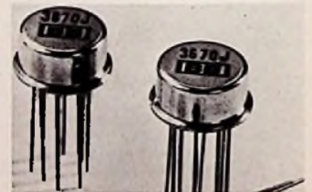
Der erste IC-Instrumentationsverstärker mit FET-Eingang heißt Burr Brown 3670. Der Verstärkungsfaktor läßt sich zwischen 0 dB und 60 dB festlegen. Der max. Eingangsstrom beträgt 10 pA, der Eingangswiderstand 1013 \Omega und die Gleichtakt-Unterdrückung je nach gewähltem Verstärkungsfaktor 60...100 dB. (Foto: Fey)
