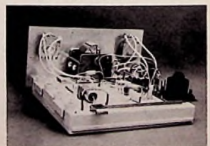
Bild 3. Versuchsaufbau der Schaltung nach Bild 2 auf einer Hirschmann-Experimentierplatte XP 101
