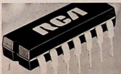
Als schneller Schalter, Speicher-, Relais- und Lampentreiber eignen sich die Hochstrom-Transistor-Arrays von RCA. (Foto: Enatechnik)
