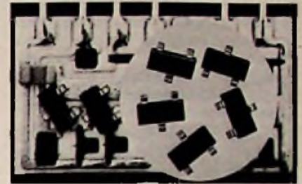
Dickschichtschaltungen werden in immer größerem Umfang auf nahezu allen Gebieten der Elektronik eingesetzt. Zur Integration werden Bauelemente verschiedener Technologien verwendet; für diese Art von „IS“ wurden Transistoren im Miniaturl-Gehäuse SOT 23 entwickelt. (Foto: AEG/Telefunken)
