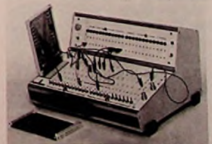
Bild 4. Logikprüfgerät LOG 38 für 31- oder 64polige Flachbaugruppen (Siemens)
