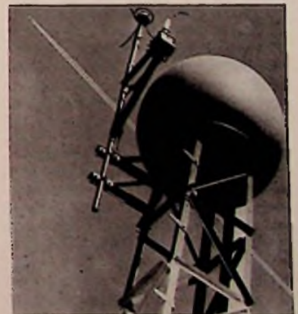
Radargerät »Corail« zur Flughafenüberwachung (Foto: LCT/ITT)
