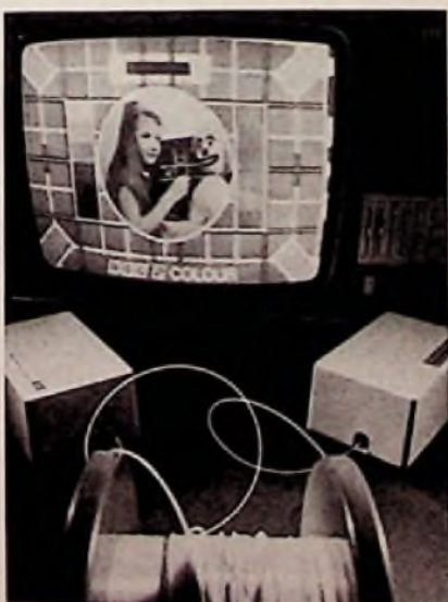
Übertragung eines Farbfernsehbildes ohne merkbare Verluste durch eine 70 µm dicke Glasfaser von mehreren hundert Metern Länge (Foto: STL/ITT)
