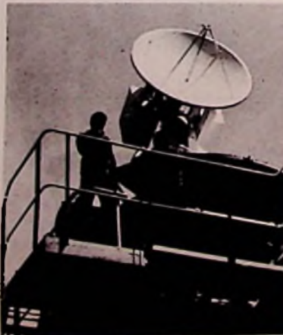
Millimeterwellen-Radargerät am Raketen-Startplatz Kourou (Foto: LCT/ITT)
