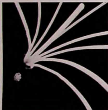
Beispiel eines aus acht kunststoffummantelten Glasfasern bestehenden Kabels mit einem Zugkräfte aufnehmenden Mittelstrang. Die theoretische Übertragungskapazität dieses Kabels beträgt mehr als 1 Mio. Sprechkreise (über 80 Gbit/s.) (Foto: STL/ITT)
