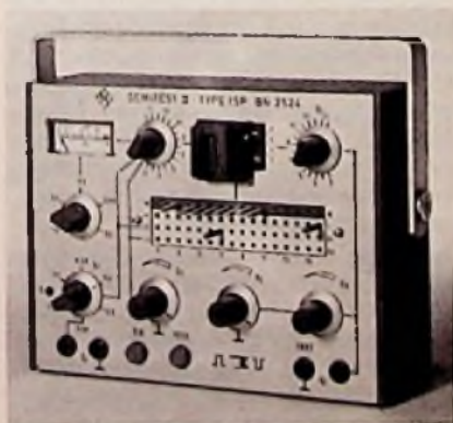
Bild 3. Labortester ISP, ein vielseitiger handlicher Funktionstester (Rohde & Schwarz)
