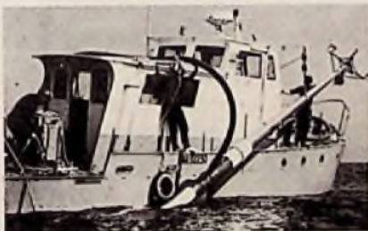
Leichte Boje L 55 für ozeanografische und meteorologische Messungen beim Wassern (Foto: LCT/ITT)
