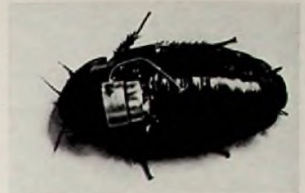
Bild 1. Küchenschabe mit appliziertem Miniatursender zur Telemetrie von Beschleunigungswerten [6].
