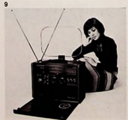
Bild 9. Praktisch alle Rundfunkempfangsmöglichkeiten bietet dieses neue Empfangsgerät RF-8000 von Matsushita. Es ist in 24 Empfangsbereiche unterteilt (davon 12 KW-Bereiche), kann jedoch auch alle kommerziellen Dienste empfangen, da es für SSB und CW eingerichtet ist. Wir kommen auf dieses Modell noch näher zurück.
