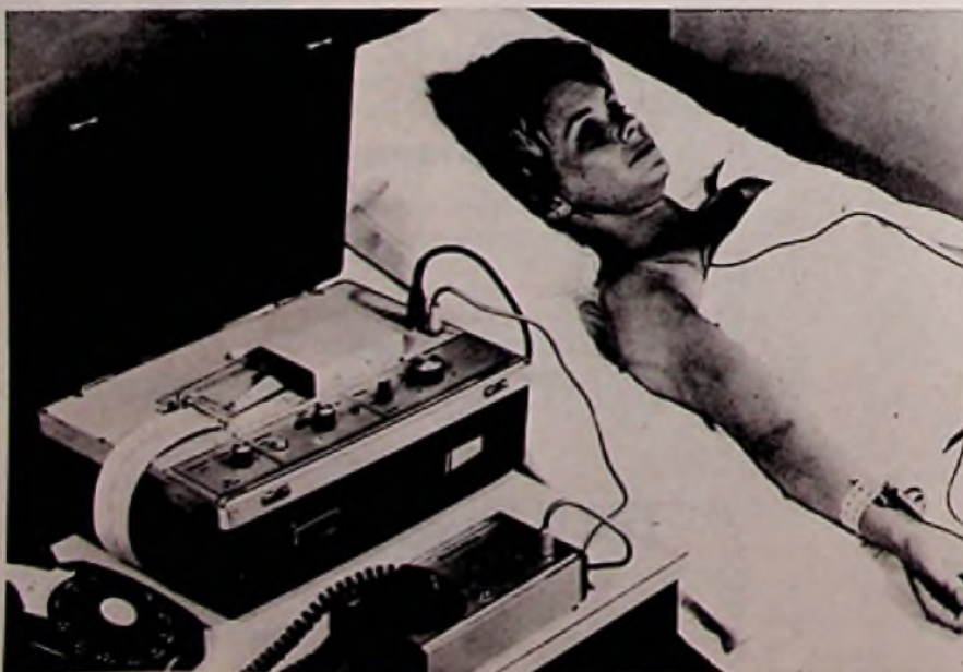
Bild 3. Telemetriezusatz zum EKG-Aufnahmegerät zur akustischen Übertragung über Telefonleitung (Kent Cambridge Medical Ltd.).
