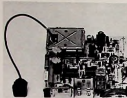
Der in den FS-Empfänger eingebaute Ultraschall-Empfänger.
