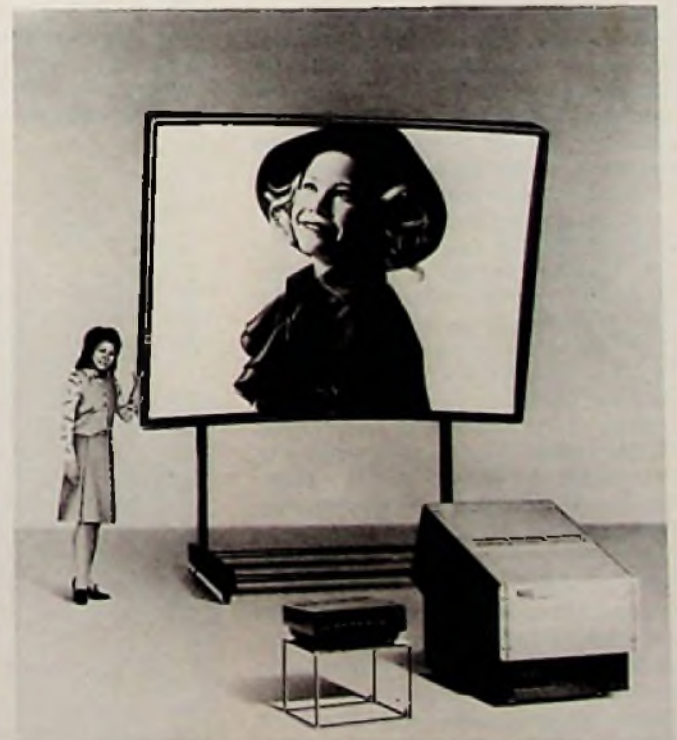
tron-Farbbildröhren, je eine für Rot, Grün und Blau. Auf den Bildschirm jeder dieser Röhren ist eine Korrekturlinse aufgesetzt. Die Rot- und Blau-Bilder werden über einen halbdurchlässigen Spiegel und eine Projektionslinse, das Grün-Bild wird unmittelbar über eine zweite Projektionslinse auf den großen Bildschirm geworfen. Das neue System, zu dem der Video-Projektor, der Bildschirm mit Standfuß und ein kleines Video-Steuergerät gehört, soll im Oktober 1975 in Japan auf den Markt kommen und umgerechnet etwa 60 000 DM kosten.
