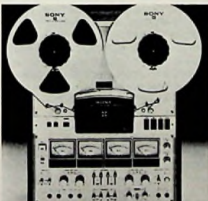
Marke: Sony Modellname: TC-788-4 Erstlieferung a. d. Handel: Sept. 1975 Endverkaufspreis: bei 3500 DM Spurzahl: 2 Bandgeschwindigkeiten: 19 u. 38 cm/s Max. Spulendurchmesser: 26 cm
