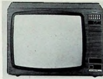
Marke: Siemens Modellname: Bildmeister FC 426 Ultraschall Erstlieferung a. d. Handel: September 1975 Endverkaufspreis: könnte vielleicht bei etwa 2100 DM liegen Bilddiagonale: 67 cm Fernbedienung: Ultraschall Gehäuseausführung: Nußbaum, Weiß
