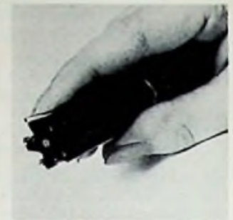
Oben: Bei dem Entwicklungsmuster von AEG-Licht-Leitkabeln wird über Stahldrähte im Zentrum zugentlastet. Vorteile des neuen Übertragungsmediums: große Bandbreite, kleine Abmessungen und geringe Störanfälligkeit.
