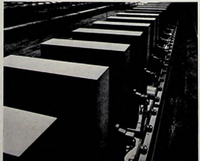
Unten: Etwa 70 Prozent aller Frühausfälle werden beim 24-Stunden-Betriebstest der Saba Farbfernsehgeräte erkannt. Täglich laufen etwa 1000 Geräte, voreingestellt und abgeglichen, über das Burn-In-Band in Villingen.
