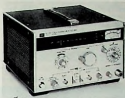
HF-Generator 8654 B für AM und FM
