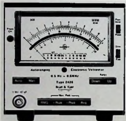
NF-Voltmeter 2426 mit automatischer Bereichsumschaltung
