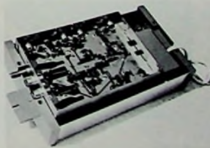
Der Fuba-VKN-Verstärker für kleine Anlagen hat einen Ausgang.
