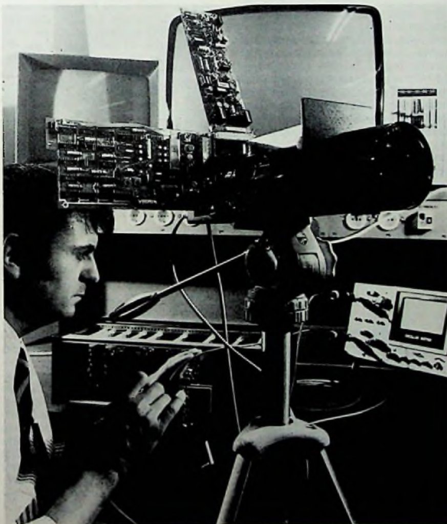
Die geöffnete Kompakt-Kamera von Siemens.
