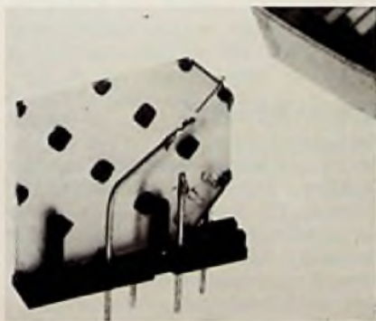
Im Volumen erheblich reduziert: die Miniatur-Pal-Verzögerungsleitung.
