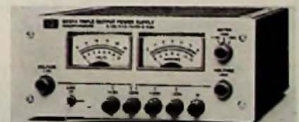
Das Labornetzgerät 6237 A liefert drei Ausgangsspannungen.
