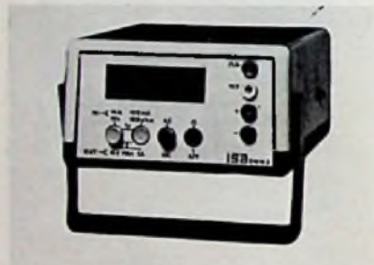
Hersteller: Wessels Meßtechnik Bezeichnung: DMM-3 Anzeige: Led, \pm 1999 Bereiche: 15 (DCV, DCI, ACV, ACI, R) Auflösung: 1 mV; 1 \Omega Meßfehler: \pm 0,5%; \pm 1% Stromversorgung: Batterie, Netz-Akku Gewicht: 900 g Preis: 385 DM
