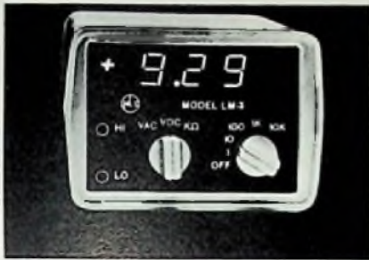
Hersteller: Non-Linear-Systems Bezeichnung: LM-3 Anzeige: Led, \pm 999 Bereiche: 13 (DCV, ACV, R) Auflösung: 1 mV; 1 \Omega Meßfehler: \pm 1,1\% ; \pm 1,1\% Stromversorgung: Netz, Akku, Batterie Gewicht: 260 g Preis: 395 DM
