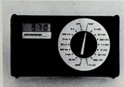
Hersteller: Dana Electronics Bezeichnung: 2000 Anzeige: Flüssigkristall, \pm 1999 Bereiche: 18 (DCV, ACV, DCI, ACI, R) Auflösung: 1 mV; 0,1 \Omega Meßfehler: \pm 0,55\% ; \pm 3,15\% Stromversorgung: Batterie Gewicht: 450 g Preis: 775 DM
