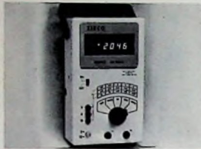
Hersteller: Zierold OHG Bezeichnung: ZD 2001/ZD 2001 A Anzeige: Led, \pm 1999 Bereiche: 25 (DCV, DCI, ACV, ACI, R) Auflösung: 0,1 mV; 0,1 \Omega Meßfehler: \pm 0,2%; \pm 1% Stromversorgung: Batt./Netz-Akku Gewicht: 750 g Preis: 488 DM/535 DM
