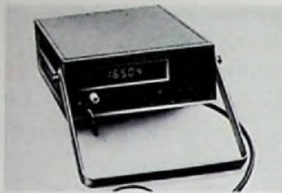
Hersteller: Tekelec Bezeichnung: TA 365 Anzeige: Flüssigkristall, \pm 19999 Bereiche: 25 (DCV, ACV, DCI, ACI, R) Auflösung: 10 \mu V; 0,01 \Omega Meßfehler: \pm 0,05\% ; \pm 0,12\% Stromversorgung: Netz Gewicht: 2,05 kg Preis: 1629 DM
