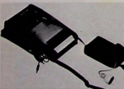
Hersteller: Tekelec Bezeichnung: TA 356 Anzeige: Flüssigkristall, \pm 1999 Bereiche: 25 (DCV, ACV, DCI, ACI, R) Auflösung: 0,1 mV; 0,1 \Omega Meßfehler: \pm 0,15\% ; \pm 0,2\% Stromversorgung: Netz, Akku Gewicht: 1080 g Preis: 678 DM
