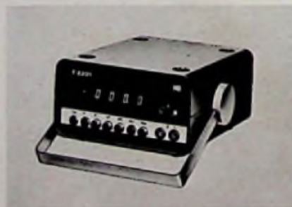
Hersteller: Hartmann & Braun Bezeichnung: T 2201 Anzeige: Röhren, \pm 6144 Bereiche: 15 (DCV, ACV, R) Auflösung: 0,1 mV; 0,1 \Omega Meßfehler: \pm 0,1\% ; \pm 0,5\% Stromversorgung: Netz, Akku Gewicht: 2,5 kg Preis: 1190 DM
