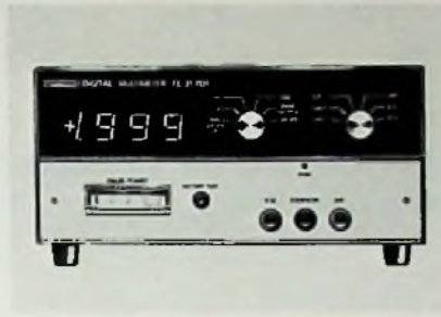
Hersteller: Metrawatt Bezeichnung: FE 31 1101 Anzeige: Röhren, \pm 1999 Bereiche: 26 (DCV, ACV, DCI, ACI, R) Auflösung: 0,1 mV; 0,1 \Omega Meßfehler: \pm 0,1\% ; \pm 0,5\% Stromversorgung: Netz, Akku Gewicht: 3 kg Preis: 750 DM
