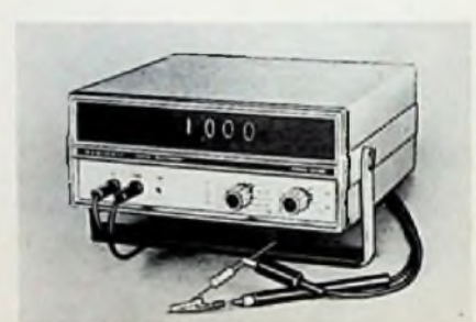
Hersteller: Heathkit Bezeichnung: IM-102 Anzeige: Röhren, \pm 1999 Bereiche: 26 (DCV, DCI, ACV, ACI, R) Auflösung: 0,1 mV; 0,1 \Omega Meßfehler: \pm 0,2%; \pm 0,5% Stromversorgung: Netz Gewicht: 4,3 kg Bausatz: 968 DM, Gerät: 1177 DM
