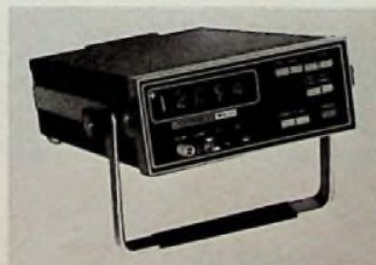
Hersteller: Non-Linear-Systems Bezeichnung: LX-2 Anzeige: Röhren, \pm 19999 Bereiche: 13 (DCV, ACV, R) Auflösung: 0,1 mV; 0,1 \Omega Meßfehler: \pm 0,03\% ; \pm 0,03\% Stromversorgung: Netz, Akku Gewicht: 4,8 kg Preis: 1390 DM
