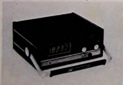
Hersteller: Data Precision Bezeichnung: Modell 1455 Anzeige: \pm 19999 Bereiche: 21 (DCV, DCI, ACV, ACI, R) Auflösung: 0,1 mV; 0,1 \Omega Meßfehler: \pm 0,02%; \pm 0,07% Stromversorgung: Netz Gewicht: 1700 g Preis: 1270 DM
