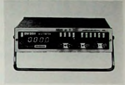
Hersteller: System electronic Bezeichnung: DV 204 Anzeige: Led, \pm 1999 Bereiche: 26 (DCV, ACV, DCI, ACI, R) Auflösung: 0,1 mV; 0,1 m \Omega Meßfehler: \pm 0,15\% ; \pm 0,15\% Stromversorgung: Netz, Akku Gewicht: 1,2 kg Preis: 850 DM
