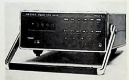
Hersteller: Philips Bezeichnung: PM 2522 Anzeige: Led, \pm 1999 Bereiche: 26 (DCV, ACV, DCI, ACI, R) Auflösung: 0,1 mV; 0,1 \Omega Meßfehler: \pm 0,1\% ; \pm 0,2\% Stromversorgung: Netz, Akku Gewicht: 2 kg Preis: 950 DM
