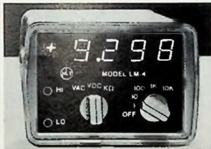
Hersteller: Non-Linear-Systems Bezeichnung: LM 4 Anzeige: Led, \pm 9999 Bereiche: 13 (DCV, ACV, R) Auflösung: 0,1 mV; 0,1 \Omega Meßfehler: \pm 0,02\% ; \pm 0,1\% (Bereichs-Endwerte) Stromversorgung: Netz, Akku, Batterie Gewicht: 260 g Preis: 740 DM
