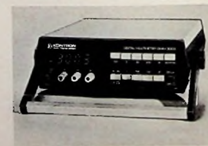
Hersteller: Kontron Bezeichnung: DMM 3002/DMM 3003 Anzeige: Led, \pm 1999/\pm 2999 Bereiche: 26/32 (DCV, DCI, ACV, ACI, R) Auflösung: 0,1 mV; 0,1 \Omega Meßfehler: \pm 0,08\% ; \pm 0,2\% Stromversorgung: Netz, Akku Gewicht: 2,5 kg Preis: 595 DM/720 DM
