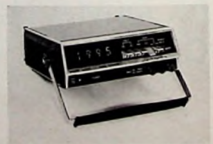
Hersteller: Philips Bezeichnung: PM 2423 Anzeige: Röhren, \pm 1999 Bereiche: 15 (DCV, ACV, R) Auflösung: 1 mV; 0,1 \Omega Meßfehler: \pm 0,1\% ; \pm 0,5\% Stromversorgung: Netz Gewicht: 2 kg Preis: 990 DM
