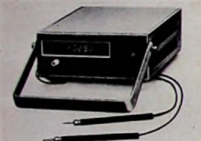
Hersteller: Tekelec Bezeichnung: TA 355 Anzeige: Flüssigkristall, \pm 1999 Bereiche: 25 (DCV, ACV, DCI, ACI, R) Auflösung: 0,1 mV; 0,1 \Omega Meßfehler: \pm 0,1\% ; \pm 0,15\% Stromversorgung: Netz, Akku Gewicht: 2050 g Preis: 595 DM
