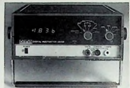
Hersteller: Dana Electronics Bezeichnung: 3800 B Anzeige: \pm 1999 Bereiche: 21 (DCV, ACV, DCI, R) Auflösung: 0,1 mV; 0,1 \Omega Meßfehler: \pm 0,1\% ; \pm 0,2\% Stromversorgung: Netz Gewicht: 2,7 kg Preis: 1160 DM
