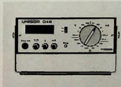
Hersteller: Metrawatt Bezeichnung: Unigor D 410 Anzeige: Led, \pm 1999 Bereiche: 29 (DCV, DCI, ACV, ACI, R) Auflösung: 0,1 mV; 0,1 \Omega Meßfehler: \pm 0,1\% ; \pm 0,5\% Stromversorgung: Netz Gewicht: 3,5 kg Preis: 980 DM
