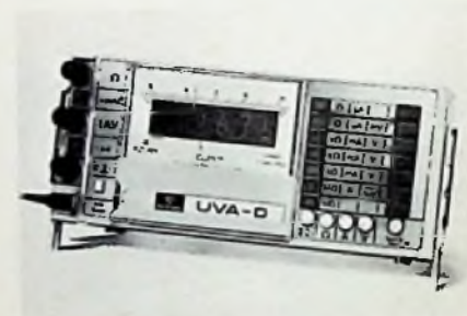
Hersteller: Norma Meßtechnik Bezeichnung: UVA-D Anzeige: Röhren, \pm 1999 Bereiche: 29 (DCV, DCI, ACV, ACI, R) Auflösung: 0,1 mV; 10 m \Omega Meßfehler: \pm 0,1\% ; \pm 0,8\% Stromversorgung: Netz Gewicht: 1,7 kg Preis: 1145 DM
