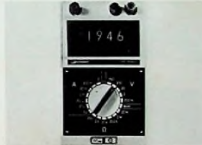
Hersteller: Metrawatt Bezeichnung: Metravo digital Anzeige: Röhren, \pm 1999 Bereiche: 30 (DCV, DCI, ACV, ACI, R) Auflösung: 0,1 mV; 0,1 \Omega Meßfehler: \pm 0,2\% ; \pm 0,4\% Stromversorgung: Netz, Akku Gewicht: 1,3 kg Preis: 890 DM
