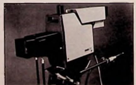
Durch externe Synchronisation ist die Kamera auch für das Genlock-System verwendbar
