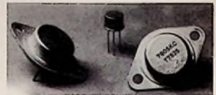
Die Spannungsregler von Transitron im T0-3- bzw. T0-5-Gehäuse
