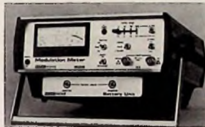
Sämtliche Funktionen und Bereiche sind mit TTL-Signalen programmierbar
