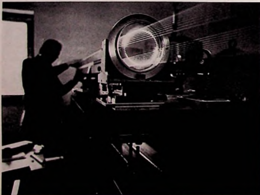
Mit Hilfe eines Lasers wollen Wissenschaftler des Max-Planck-Instituts für Physik und Astrophysik in München aus dem Weltraum kommende Schwerkraftwellen registrieren. Mit dieser Meßanordnung läßt sich die Empfindlichkeit im Vergleich zu den bisher als Gravitationswellen-Antennen benutzten massiven Aluminium-Zylindern wahrscheinlich wesentlich steigern. (Bild: MPG/Blachlan)
