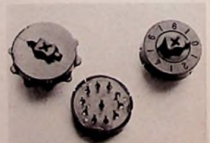
Die Dreheschalter sind BCD-codiert
