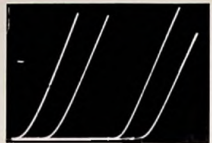
Bild 27. Kennlinien einer Back-To-Back-Dioden-Kombination
