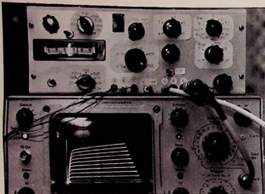
Bild 20. Frontseite des Kennlinienschreibers mit angeschlossenem Oszilloskop
