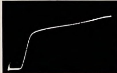
Bild 32. Kennlinie einer Leuchtdiode mit eigener Konstantstromquelle
