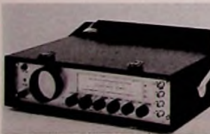
Marke: Siemens Modell: S 43202-M-C Bereich: Fernsehen, UKW Pegelbereich: 30–130 dB \mu V Meßunsicherheit: \pm 2 dB Anzeige: Oszilloskop, Zeiger Tonwiedergabe: nein Stromversorgung: Netz, Batterie/Akku Gewicht: 11 kg Preisbeobachtung: etwa 3500 DM
