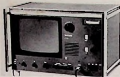
Marke: Philips Modell: T 111 Bereich: Fernsehen Pegelbereich: 37–133 dB \mu V Meßunsicherheit: \pm 2 dB Anzeige: Bild, Zeiger Tonwiedergabe: Lautsprecher Stromversorgung: Netz, Akku Gewicht: 10 kg Preisbeobachtung: etwa 2100 DM
