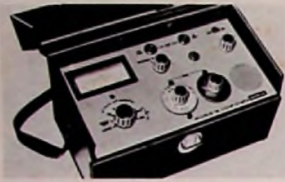
Marke: Metrix Modell: VX 409 A Bereich: Fernsehen, Hör-Rundfunk Pegelbereich: 20–90 dB \mu V Meßunsicherheit: \pm 3 dB (Fernseh-Bd. I/III, UKW); \pm 6 dB (Fernseh-Bd. IV/V) Anzeige: Zeiger Tonwiedergabe: Lautsprecher Stromversorgung: Batterie Gewicht: 6 kg Preisbeobachtung: etwa 1200 DM
