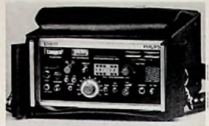
Marke: Philips Modell: ESB 111 Bereich: 0,15–150 MHz Pegelbereich: 20–120 dB \mu V Meßunsicherheit: \pm 2 dB Anzeige: Zeiger, Digitalanzeige Tonwiedergabe: Lautsprecher Stromversorgung: Batterien, Akku Gewicht: 5,8 kg Preisbeobachtung: etwa 2700 DM
