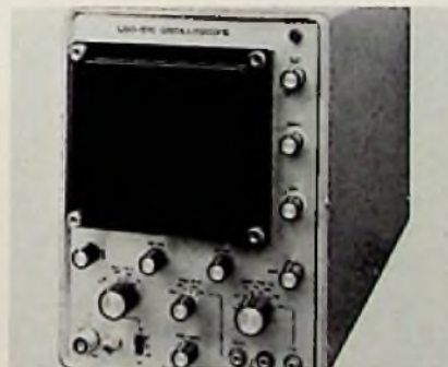
Marke: Leader Modell: LBO-510 Schirmgröße: 8 cm x 10 cm Y-Grenzfrequenz: 4 MHz Y-Koeff.: 20 mV/T ... 2 V/T Zeit-Koeff.: — Dehnung: nein Trigger: nein, Synchron. 10 Hz ... 100 kHz Eichquelle eingeb.: ja Gewicht: 4 kg Preisbeobachtung: etwa 660 DM
