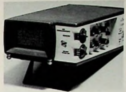
Marke: Tektronix Modell: 221 Portable Schirmgröße: 3 cm x 5 cm Y-Grenzfrequenz: 5 MHz Y-Koeff.: 5 mV/T ... 100 V/T Zeit-Koeff.: 1 µs/T ... 200 ms/T Dehnung: 10fach Trigger: auto, frei, +/- Eichquelle eingeb.: nein Gewicht: 1,6 kg mit Akku Preisbeobachtung: etwa 3500 DM mit Akku
