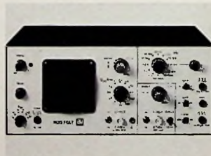
Marke: Rim electronic Modell: ROG 7 GLT Schirmgröße: 7 cm Durchmesser Y-Grenzfrequenz: 10 MHz Y-Koeff.: 30 mV/T ... 20 V/T Zeit-Koeff.: — Dehnung: — Trigger: nein, Synchron. 7 Hz ... 900 kHz, TV Eichquelle eingeb.: ja Gewicht: 6 kg Preisbeobachtung: etwa 750 DM; Bausatz 600 DM
