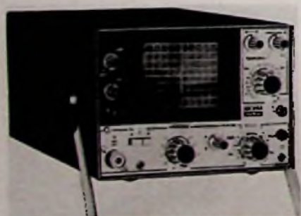
Marke: Metrix Modell: OX 318 A Schirmgröße: 5,6 cm x 7 cm Y-Grenzfrequenz: 15 MHz Y-Koeff.: 10 mV/T ... 50 V/T Zeit-Koeff.: 0,5 µs/T ... 0,5 s/T Dehnung: 5fach Trigger: auto, frei, +/-, TV Eichquelle eingeb.: ja Gewicht: 5,3 kg Preisbeobachtung: etwa 2000 DM
