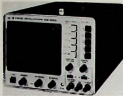
Marke: Trlo Modell: CO-1505 Schirmgröße: 8 cm x 10 cm Y-Grenzfrequenz: 1,5 MHz Y-Koeff.: 20 mV/T ... 20 V/T Zeit-Koeff.: — Dehnung: — Trigger: nein, Synchron. 10 Hz ... 100 kHz Eichquelle eingeb.: ja Gewicht: 5,2 kg Preisbeobachtung: etwa 600 DM
