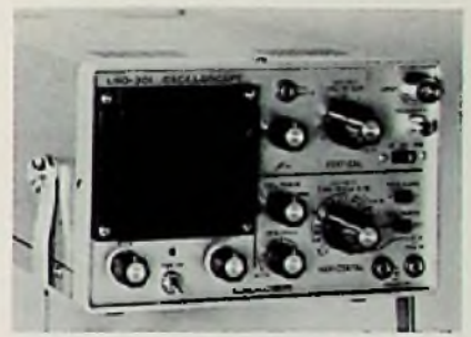
Marke: Leader Modell: LBO-301 Schirmgröße: 6 cm x 4,8 cm Y-Grenzfrequenz: 5 MHz Y-Koeff.: 10 mV/T ... 5 V/T Zeit-Koeff.: 2 µs/T ... 0,2 s/T Dehnung: 5fach Trigger: auto, frei, +/- Eichquelle eingeb.: ja Gewicht: 4 kg Preisbeobachtung: etwa 1300 DM
