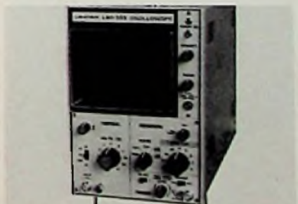
Marke: Leader Modell: LBO-503 Schirmgröße: 8 cm x 10 cm Y-Grenzfrequenz: 10 MHz Y-Koeff.: 10 mV/T ... 20 V/T Zeit-Koeff.: 0,5 µs/T ... 0,2 s/T Dehnung: 5fach Trigger: auto, frei, +/-, TV Eichquelle eingeb.: ja Gewicht: 5,7 kg Preisbeobachtung: etwa 1350 DM
