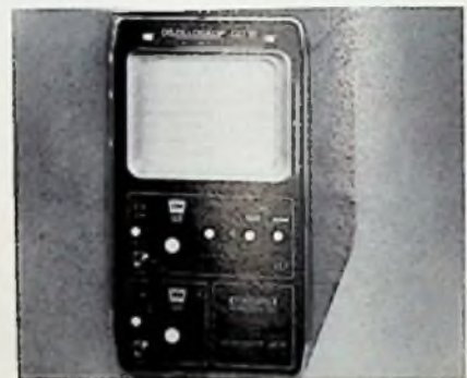
Marke: Grundig electronic Modell: GO 15 Schirmgröße: 8 cm x 10 cm Y-Grenzfrequenz: 15 MHz Y-Koeff.: 5 mV/T ... 20 V/T Zeit-Koeff.: 0,3 µs/T ... 100 ms/T Dehnung: 3fach Trigger: auto, frei, TV, +/- Elchquelle eingeb.: ja Gewicht: 9,8 kg Preisbeobachtung: etwa 1100 DM
