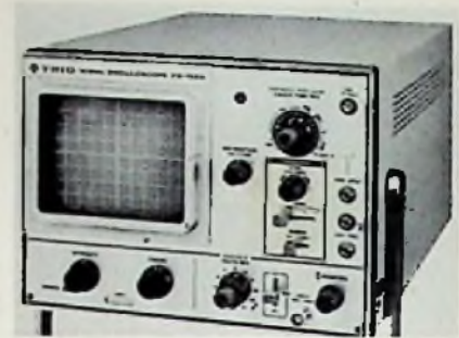
Marke: Trlo Modell: CS-1559 Schirmgröße: 8 cm x 10 cm Y-Grenzfrequenz: 10 MHz Y-Koeff.: 10 mV/T ... 20 V/T Zeit-Koeff.: 1 µs/T ... 0,5 s/T Dehnung: 5fach Trigger: auto, frei, +/-, TV Eichquelle eingeb.: ja Gewicht: 8 kg Preisbeobachtung: etwa 850 DM
