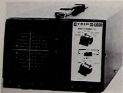
Marke: Trlo Modell: CO-1303 D Schirmgröße: 7 cm Durchmesser Y-Grenzfrequenz: 1,5 MHz Y-Koeff.: 20 mV/T ... 2 V/T Zeit-Koeff.: — Dehnung: — Trigger: nein, Synchron. 10 Hz ... 100 kHz Eichquelle eingeb.: nein Gewicht: 3,8 kg Preisbeobachtung: etwa 400 DM
