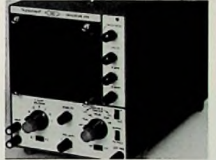
Marke: Telequipment Modell: S 51 B Schirmgröße: 8 cm x 10 cm Y-Grenzfrequenz: 3 MHz Y-Koeff.: 100 mV/T ... 50 V/T Zeit-Koeff.: 1 µs/T ... 100 ms/T Dehnung: nein Trigger: auto, frei, +/-, TV Eichquelle eingeb.: nein Gewicht: 7,3 kg Preisbeobachtung: etwa 800 DM
