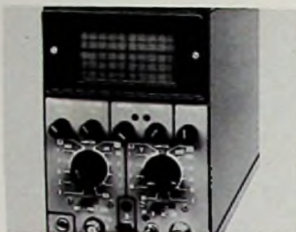
Marke: Nordmende electronics Modell: SO 10 Schirmgröße: 3,6 cm x 6 cm Y-Grenzfrequenz: 10 MHz Y-Koeff.: 5 mV/T ... 20 V/T Zeit-Koeff.: 0,5 µs/T ... 5 ms/T Dehnung: bis 8fach Trigger: auto, frei, +/-, TV Eichquelle eingeb.: nein Gewicht: 4 kg Preisbeobachtung: etwa 700 DM
