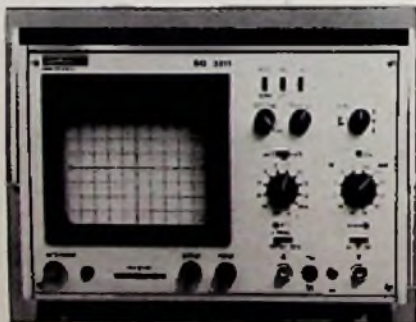
Marke: Nordmende electronics Modell: SO 3311 Schirmgröße: 8 cm x 10 cm Y-Grenzfrequenz: 12,5 MHz Y-Koeff.: 10 mV/T ... 50 V/T Zeit-Koeff.: 0,1 µs/T ... 50 ms/T Dehnung: 3fach Trigger: auto, frei, +/-, TV Eichquelle eingeb.: ja Gewicht: 8,2 kg Preisbeobachtung: etwa 1250 DM
