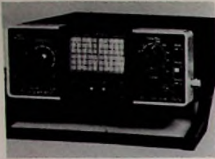
Marke: Telequipment Modell: S 22 Schirmgröße: 3,5 cm x 6 cm Y-Grenzfrequenz: 5 MHz Y-Koeff.: 10 mV/T ... 5 V/T Zeit-Koeff.: 1 µs/T ... 300 ms/T Dehnung: 10fach Trigger: auto, frei, +/-, TV Eichquelle eingeb.: ja Gewicht: 4,5 kg mit Akku Preisbeobachtung: etwa 1450 DM mit Akku
