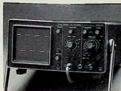
Marke: Philips Modell: PM 3225 Schirmgröße: 6 cm x 7,5 cm Y-Grenzfrequenz: 15 MHz Y-Koeff.: 2 mV/T ... 10 V/T Zeit-Koeff.: 0,5 µs/T ... 0,2 s/T Dehnung: 5fach Trigger: auto, frei, +/-, TV Eichquelle eingeb.: nein Gewicht: 4,3 kg Preisbeobachtung: etwa 1300 DM
