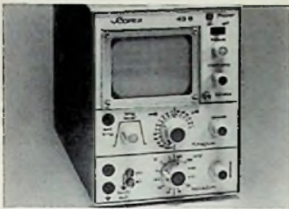
Marke: Scopex Modell: 4 S-6 Schirmgröße: 6 cm x 8 cm Y-Grenzfrequenz: 6 MHz Y-Koeff.: 10 mV/T ... 50 V/T Zeit-Koeff.: 1 µs/T ... 100 ms/T Dehnung: nein Trigger: frei, +/- Eichquelle eingeb.: nein Gewicht: 4,5 kg Preisbeobachtung: etwa 750 DM
