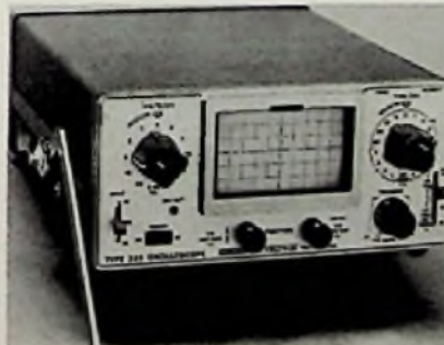
Marke: Tektronix Modell: 323 Portable Schirmgröße: 5 cm x 7 cm Y-Grenzfrequenz: 4 MHz Y-Koeff.: 10 mV/T ... 20 V/T Zeit-Koeff.: 5 µs/T ... 1 s/T Dehnung: 10fach Trigger: auto, frei, +/- Eichquelle eingeb.: ja Gewicht: 3,2 kg mit Akku Preisbeobachtung: etwa 3500 DM mit Akku
