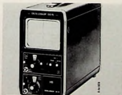
Marke: Hartmann & Braun Modell: GO 15 Schirmgröße: 8 cm x 10 cm Y-Grenzfrequenz: 15 MHz Y-Koeff.: 5 mV/T ... 20 V/T Zeit-Koeff.: 0,3 µs/T ... 100 ms/T Dehnung: 3fach Trigger: auto, frei, TV, +/- Eichquelle eingeb.: ja Gewicht: 9,8 kg Preisbeobachtung: etwa 1100 DM
