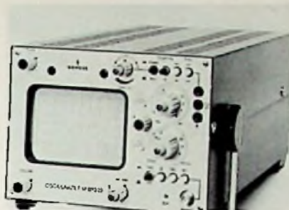
Marke: Siemens Modell: Oscillar MO 7223 Schirmgröße: 6 cm x 10 cm Y-Grenzfrequenz: 10 MHz Y-Koeff.: 5 mV/T ... 20 V/T Zeit-Koeff.: 0,2 µs/T ... 1 s/T Dehnung: nein Trigger: auto, frei, +/- Eichquelle eingeb.: ja Gewicht: 11,6 kg Preisbeobachtung: etwa 8000 DM
