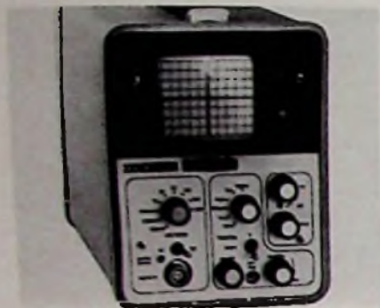
Marke: Metrix Modell: MSB 101/MSB 101-B Schirmgröße: 4 cm x 5 cm Y-Grenzfrequenz: 8 MHz Y-Koeff.: 50 mV/T ... 25 V/T Zeit-Koeff.: 50 µs/T ... 5 ms/T Dehnung: etwa 15fach Trigger: auto, frei, +/- Eichquelle eingeb.: nein Gewicht: 1,2 kg; mit Akku 1,4 kg Preisbeobachtung: etwa 800 DM ohne Akku
