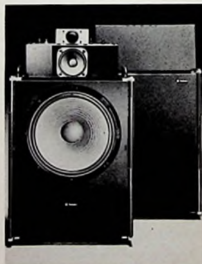
„Linear-Phase-System“ nennt National Technics sein neues Programm Baßreflex-Boxen, bei denen sich die akustischen Zentren in einer senkrechten Ebene befinden, so daß der Schall aller Systeme das Ohr zur gleichen Zeit erreicht. Hier das Modell SB-7000
