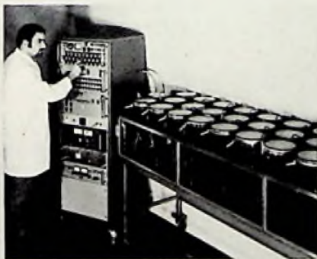
Oszillographen-Röhren in der Prüfung: Formieren der Kathode
