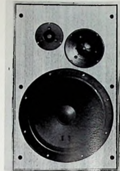
Die dänische Firma Jämo bietet eine Serie von Boxen an, die das MFB-System (Motional Feedback) von Philips verwenden.
