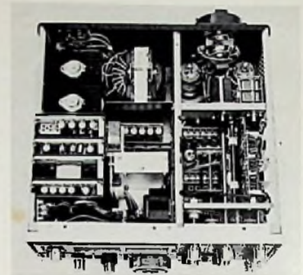
Bild 2. Blick auf das Chassis. Man erkennt hinten rechts den Ventilator und die beiden Senderröhren sowie die Drehkondensatoren des \pi -Filters, davor die Treiber- und Sendermischstufe mit den zwei 6-fach-Drehkondensatoren; links hinten Netztransformator und die Wandlertransistoren mit Kühlkörper, davor Steckmoduln und der VFO.
