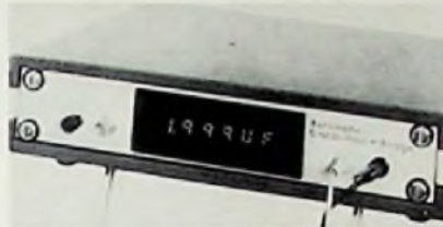
Kapazitätsmeßbrücke ESP 300 A
