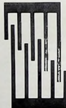
Bild 7. Bei der Suche nach einer Elektrodenstruktur für eine bestimmte gewünschte Charakteristik kann es passieren, daß man eine „schiefe“ Konfiguration findet. Dieses unerwünschte Ergebnis kann vermieden werden, wenn man bei der Filtersynthese die Schallamplituden gewissen Bedingungen unterwirft.
