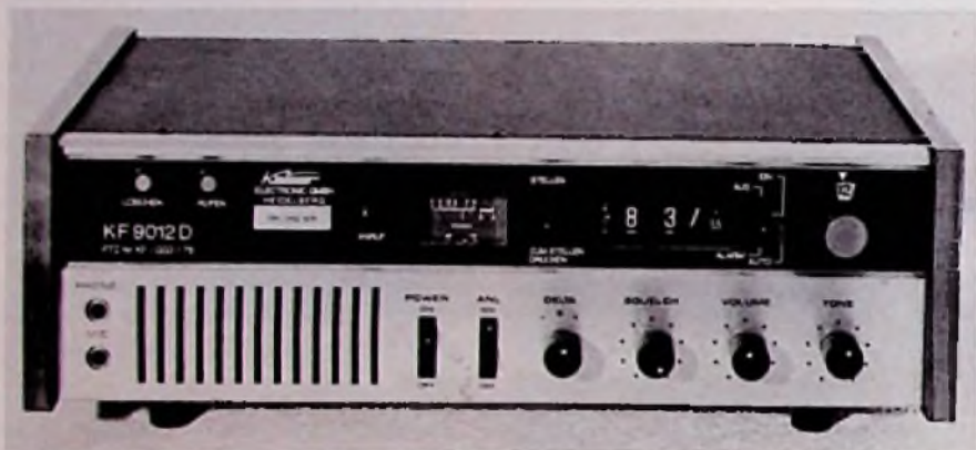
Feststation für das 11-m-Band mit 12 Kanälen und Digitaluhr
