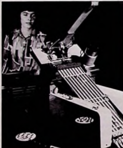
Automatische Beschickungs- und Sortiereinrichtung für ICs von Siemens
