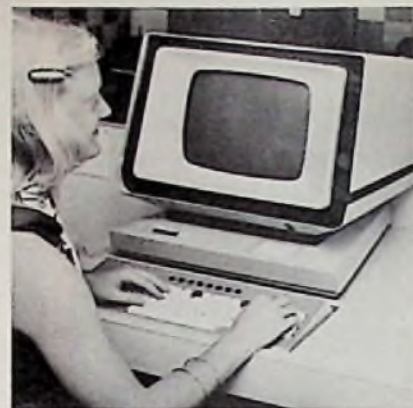
Bild 2. Bei diesem Video-Display sind Gehäuse und Frontblende aus Strukturschaum
