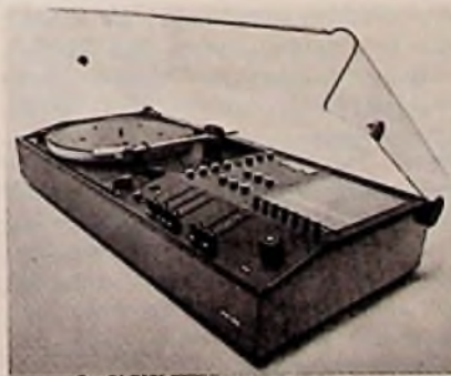
Bild 4. Braun-HI-FI-Anlage: das Gehäuse besteht aus Hostyren
