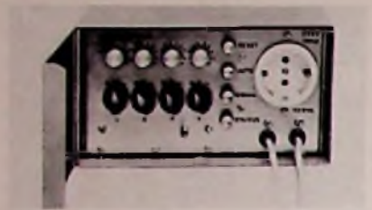
Bild 2. Rückseite des „unitek“ mit Eingangsschaltern, Pegeleinstellern und Tasten
