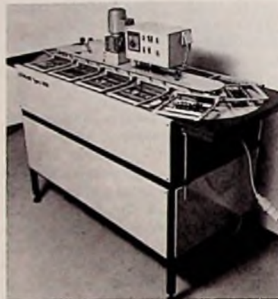
Lötanlage L 1000 der Firma Franz Köhler
