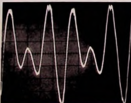
Bild 3. Test der Spurführung; Signal (1+1,5) kHz, Schnelle 20 cm/s; Lastwiderstand 100 kΩ; Auflagekraft 12 mN
