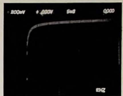
Bild 7. Gatespannung T94 beim Dolby-B-Konzept von Körting (-40 dB Dolby-Level auf 0 dB Dolby-Level; Frequenz: 5 kHz)
