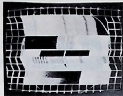
Bild 39. Bild ist verzerrt wegen Defekt im ZF-Modul (Regelspannung, Brumm-einstreuung) (Saba)
