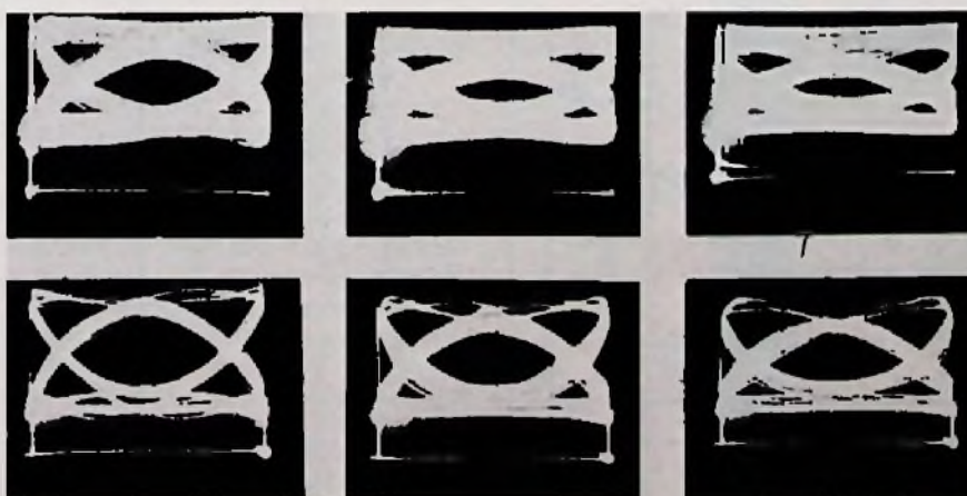
Bild 15. Augen-Diagramme von digitalen Signalen, die an derselben Antenne mit verschiedenen Empfängern (A,B,C) empfangen wurden; oben: „Teletext“-Signale (NRZ, 144 ns/bit), unten: Signale der Datenzeile (Bi-Phase, 400 ns/bit)
