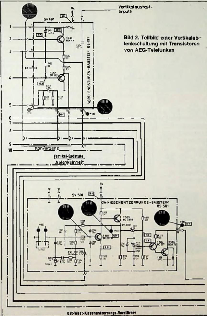
Bild 2. Teilbild einer Vertikalablenkschaltung mit Transistoren von AEG-Telefunken
