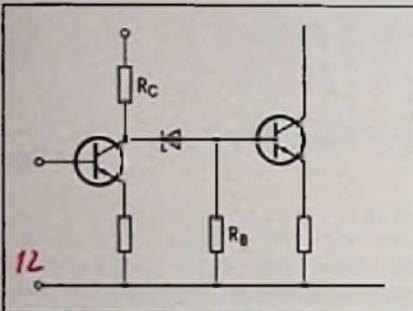
Bild 12. Z-Diode als Gleichstromkoppelglied in einem Verstärker (Siemens)
