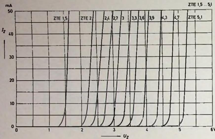
Bild 3. Durchbruchskennlinien von ZTE-Dioden (ITT)
