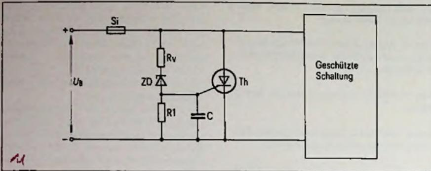
Als Z-Diode wird der Typ ZPY 6,2 gewählt. Daten dieser Z-Diode:
