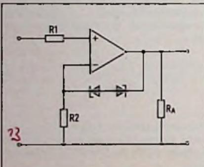
Bild 14. Nullpunktunterdrückung bzw. Zusammendrängung des Skalenanfanges bei einem Gleichspannungsmessinstrument (Siemens)
