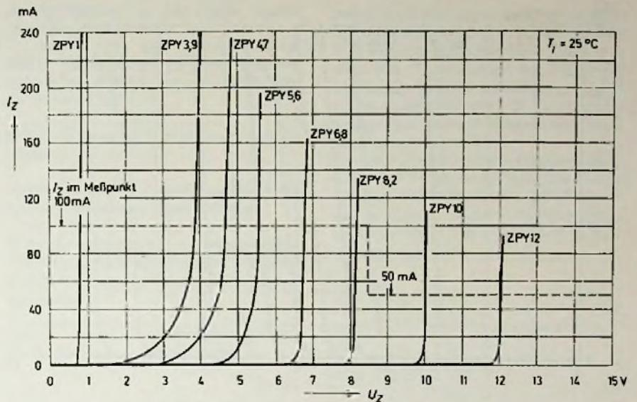
Bild 1. Durchbruchkennlinien für den Z-Diodentyp ZPY (ITT)
