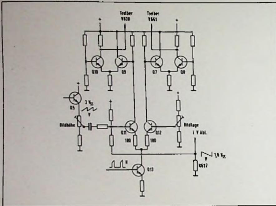
Bild 5. Vereinfachte Schaltung zum Erzeugen der Triggerimpulse
