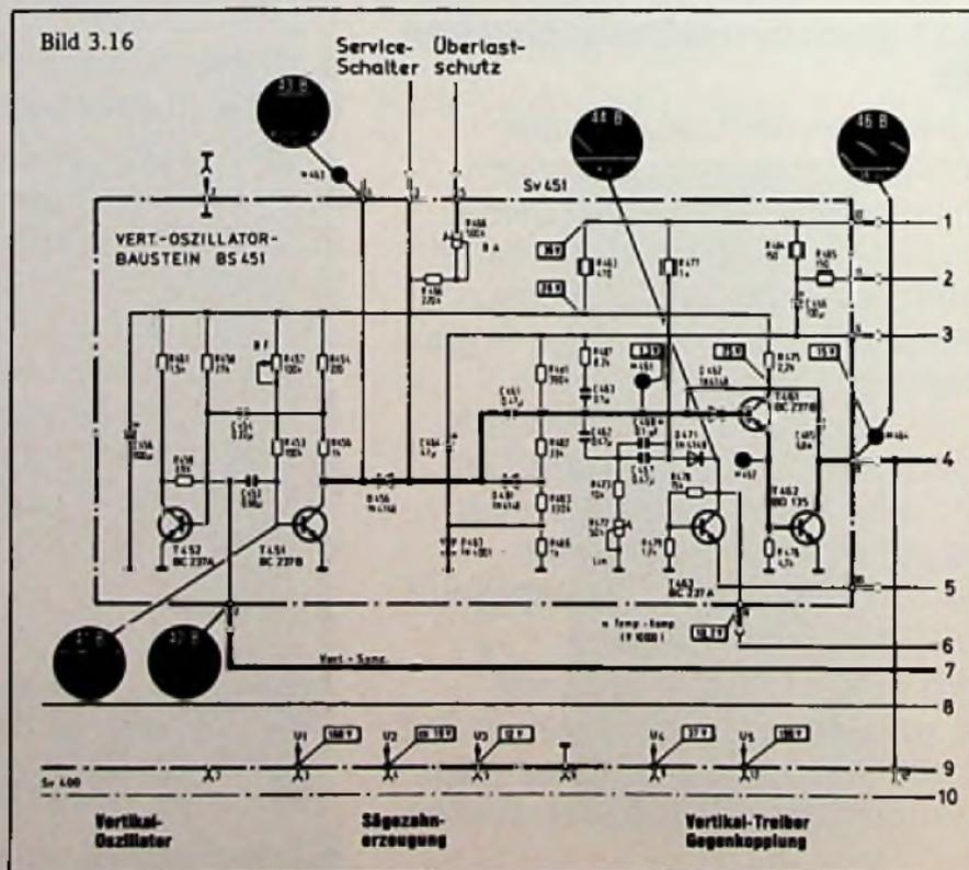
Wert der Betriebsspannung zu erreichen. Damit wurde zugleich nachgewiesen, daß die Endstufe einschließlich des Treibers steuerfähig ist. Das Gleiche wiederholt man am Meßpunkt M461 mit der Vorstufe. Rea-
