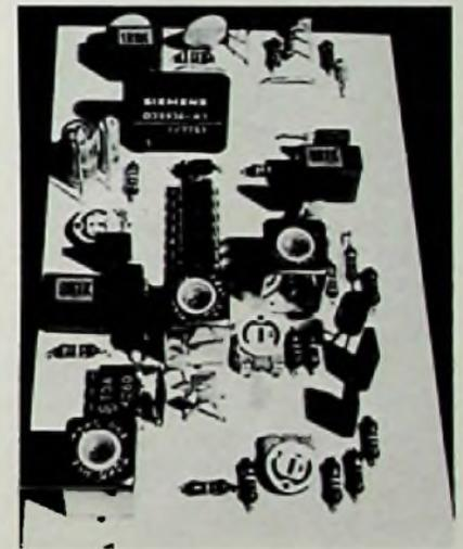
Oberflächenwellen-Filter B39936 (oben links) auf einer Platine (Siemens)
