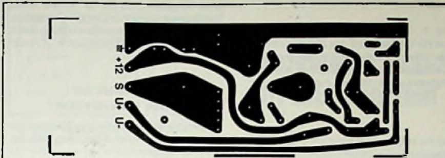
Bild 2a. Leiterplatte der Zündanlage
