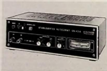
Stabilisiertes Netzgerät SN 43 A (Grundig)
