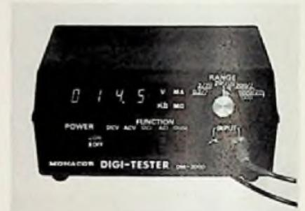
Digital-Multimeter DM-2000 (Inter-Mercador GmbH & Co. KG)
