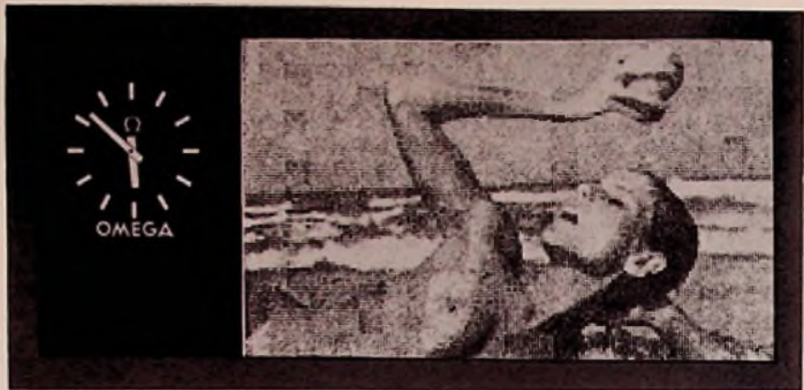
25 600 Glühlampen in hundert Zeilen erzeugen dieses Bild auf einer neuen Anzeigetafel für Sportstätten, die der Schweizer Hersteller Omega entwickelte. Ein Minicomputer steuert die Lampen bis zu 25mal in der Sekunde nacheinander an und bestimmt zugleich ihre Helligkeit in 16 Stufen. Auf diese Weise lassen sich nicht nur Schriftzeichen, sondern auch Fotos und Fernsehfilme wiedergeben. (Bild: Baier)
