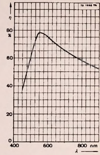
Bild 14. Wirkungsgrad in Abhängigkeit von der Wellenlänge für die Lawinen-Fotodiode BPW 28 (Telefunken)
