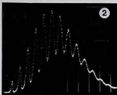
Bild 2. Impulsspektrum des Ausgangssignals. Als Eingangssignal dienen kurze Impulse aus einer Elektronenkanone; Auflösung: 0,17
