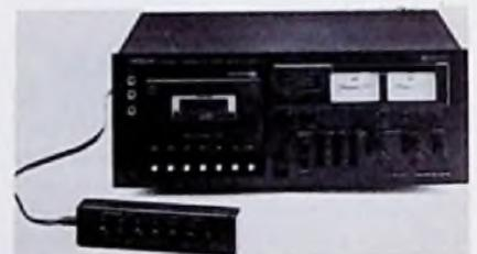
Bild 5. Hi-Fi-Stereo-Cassettendeck D-900 (Hitachi) mit getrenntem Aufnahme- und Wiedergabekopf sowie Hinterbandkontrolle
