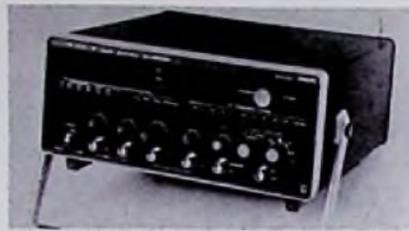
AM/FM-Prüfsender PM 5326 (Philips)
