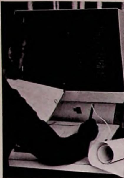
Die geometrischen Strukturen eines Zelleninhalts können bei einem neuen Layout-Programm für Halbleiterschaltungen im Dialog mit einem rechnergesteuerten Bildschirmsystem auch interaktiv entworfen werden.
