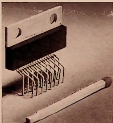
Integrierte Vertikalablenkschaltung im CB-215-Gehäuse (Thomson)
