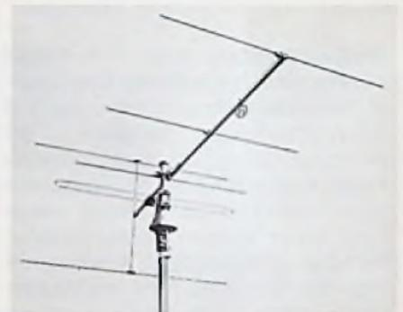
Bild 8. UKW-6-Elementantenne mit Rotor
