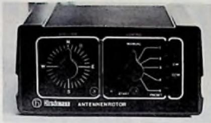
Bild 10. Steuergerät für Antennenrotor
