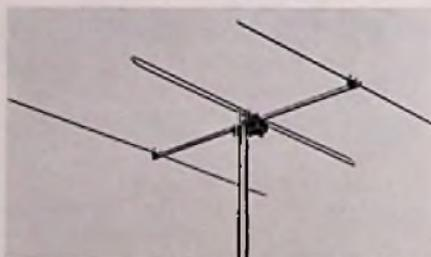
Bild 5. UKW-3-Elementantenne
