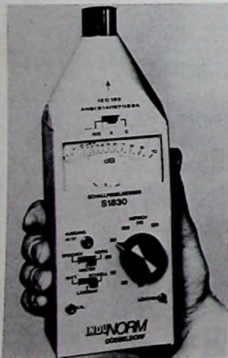
mit mehreren Speicherfunktionen, einem Schreiber Ausgang und einem Kondensator-Mikrofon ausgestattet. Als Zubehör werden eine Eichschallquelle, Stativ und Windfilter in einem handlichen Koffer angeboten.
