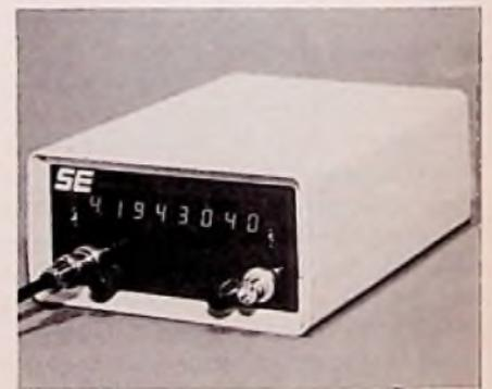
Zählerbausatz FU 7226B fertig aufgebaut (Spezial Electronic)
