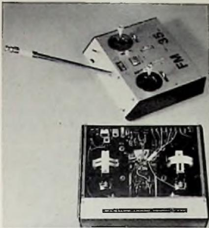
Bild 6. Gehäuseansichten des Senders; Abmessungen L x B x H in mm: 167,5 x 195 x 45
