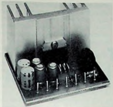
Stereo-Leistungsverstärker mit dem IC TDA 2004 (SGS-Ates)
