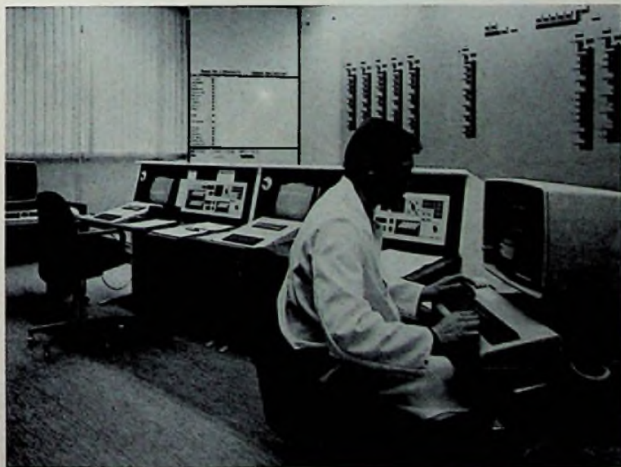
Bild 3. Das zum Steuern der Fertigung und zum Testen verwendete Computerverbundsystem umfaßt drei Großcomputer in der Zentrale und 40 Prozeßrechner
