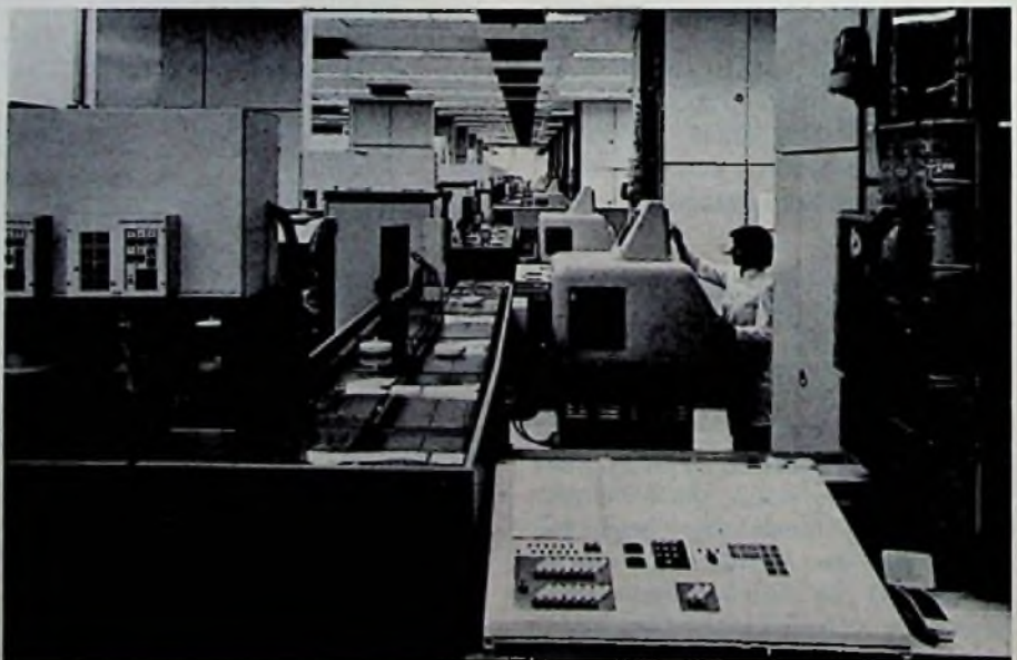
Bild 1. In dieser Fertigungsstraße sind die automatisch arbeitenden Fertigungseinrichtungen durch ein System für den berührungslosen Transport der Wafer miteinander verbunden
