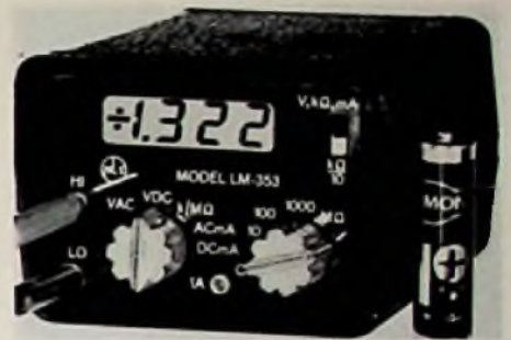
Einschließlich Batterien wiegt das Mini-Multimeter „LM-353“ nur 225 g. Eine Batteriesatz reicht für 100 h Betriebszeit
