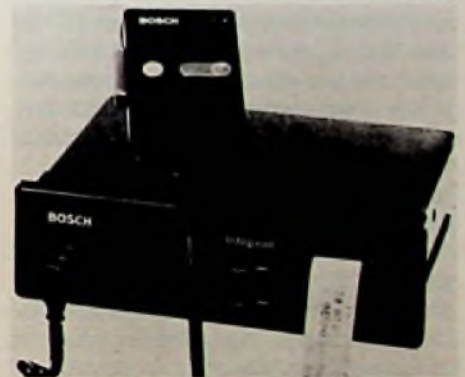
Der funkgesteuerte Drucker des Systems „Infoprint“ schreibt maximal 4 Zeilen auf Metallpapier (Bosch)
