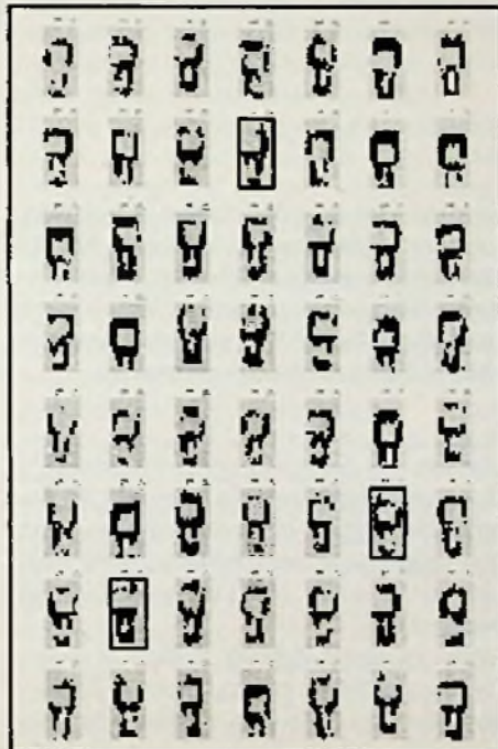
Bild 2. Rasterbilder der Ziffer 8 aus der Schnelldruckerschrift „OCR-A“
